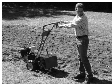
Fig. 4-3: Levante los dientes, separándolos del suelo y mire
