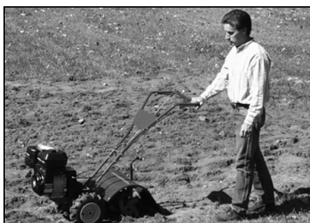
Fig. 4-2: Use una mano para guiar la cultivadora al moverse hacia adelante.
