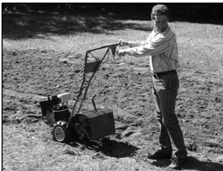
Fig. 4-3: Levante los dientes, separándolos del suelo y mire
