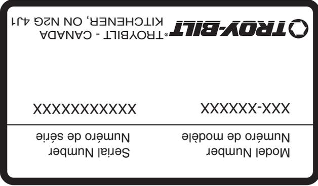
AVANT DE PROCÉDER À L'ASSEMBLAGE DE VOTRE NOUVELLE SOUFFLEUSE, localiser la plaque signalétique sur l'équipement, et recopier le numéro de modèle et le numéro de série sur le modèle de plaque signalétique fourni sur la droite. Pour localiser la plaque signalétique, placez-vous derrière la souffleuse à la poste de conduite et regardez à l'arrière du châssis de la souffleuse.
