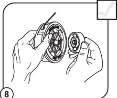
8 Sostenga a la vez el carrete interior y la bobina exterior. Hale firmemente los dos extremos de línea para sacarlos de las ranuras de sujeción. Atornille la perilla percusiva hacia la derecha. Apriete bien la perilla percusiva.
