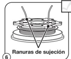
6 Inserte las dos secciones de 6 pulgadas en las dos ranuras de sujeción de 0.095 (2.41 mm).
