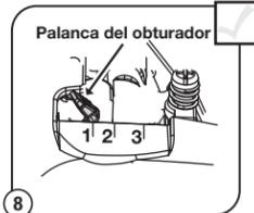
8 Coloque la palanca del obturador en la **Posición 1**.
