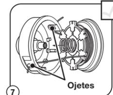
7 Pase los dos extremos de la línea por los ojetes. Ponga el resorte dentro del carrete interior. Inserte el carrete interior en la bobina exterior. Empuje a la vez el carrete interior y la bobina exterior.
