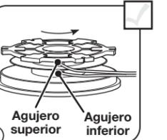
4 Inserte un extremo de la línea en el agujero exterior; y el otro, en el inferior.
