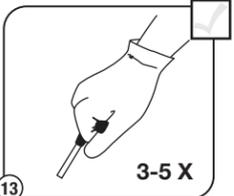
13 Tire de la cuerda de arranque fuertemente de **3 a 5** veces para arrancar el motor. Haga funcionar la unidad entre 30 y 60 segundos para calentar el motor.
