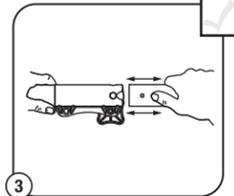
3 Quite la tapa del brazo. Empuje el accesorio de corte dentro del acoplador. Para apretar, haga girar la perilla en sentido de las agujas del reloj.
