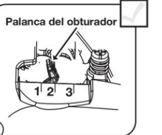
12 Mueva la palanca del obturador hasta la **Posición 2** y oprima el control del regulador.
