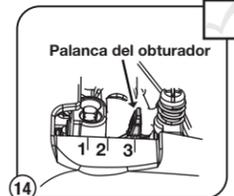
14 **Mantenga apretado el control del regulador.** Coloque la palanca del obturador en la **Posición 3**.
