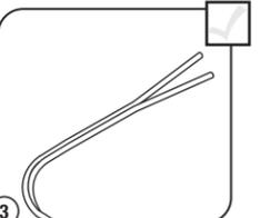
3 Corte aproximadamente 6 pies (1.8 m) de largo de una nueva línea de corte dividida de 0.095" (2.41 mm). Separe cada uno de los extremos aproximadamente 6 pulgadas (152 mm).
