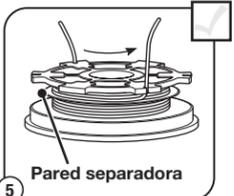
5 Enrolle firmemente la línea en el sentido indicado en el carrete interior. La pared separadora dividirá la línea. Enrolle la línea hasta que esté completamente dividida y queden aproximadamente 6 pulgadas (150 mm) de línea.
