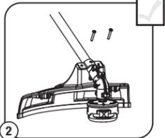
2 Coloque el **protector** sobre el **soporte de montaje**. Atornille firmemente los **2 tornillos del protector** en los orificios del soporte de montaje introduciéndolos en el protector. Asegúrese de que los tornillos estén apretados por igual, de manera que quede una separación igual entre el soporte y el protector en cada lado.
