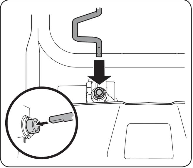
6. Poussez la tige de commande de la goulotte vers le panneau de bord jusqu'à ce que le trou de la tige soit aligné avec le trou du milieu sur l'entrée de la commande, puis insérez la goupille fendue. Voir la Figure 3-8.
