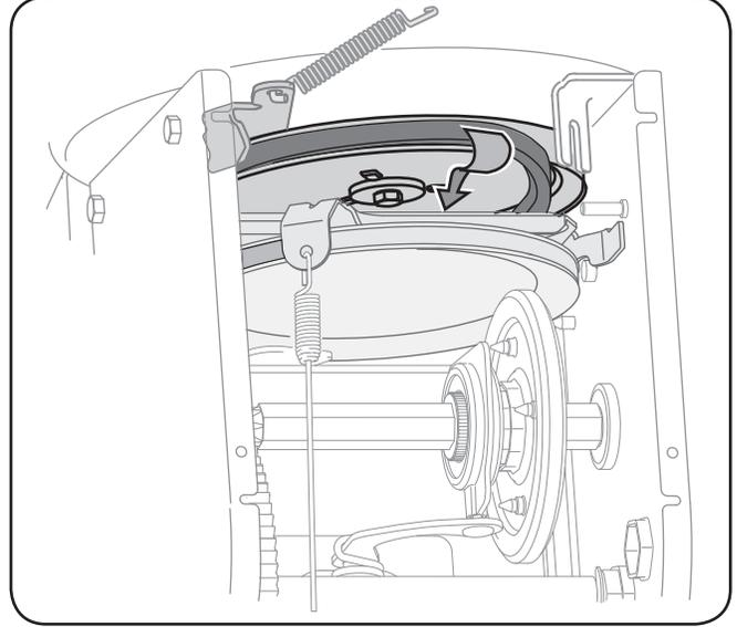
8. Dégagez la courroie de la poulie de la tarière et faites glisser la courroie en le support et la poulie de la tarière. Voir la Fig. 7-6.
