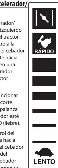
Para cortar el césped, coloque la palanca de control de velocidad en la posición "Velocidad de corte" o una velocidad de avance menor para obtener los mejores resultados.
