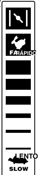
Para cortar el césped, coloque la palanca de control de velocidad en la posición "Velocidad de corte" o una velocidad de avance menor para obtener los mejores resultados.
