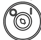
L'interrupteur est placé sur le côté gauche du tableau de bord. Lorsqu'il est placé à la position MARCHE (I), le module de commande est sous tension. Le tracteur ne peut pas être démarré si l'interrupteur n'est pas à la position MARCHE (I) et si le bouton MARCHE/ARRÊT n'est pas pressé. Placez l'interrupteur à la position ARRÊT (O) pour arrêter le tracteur.
