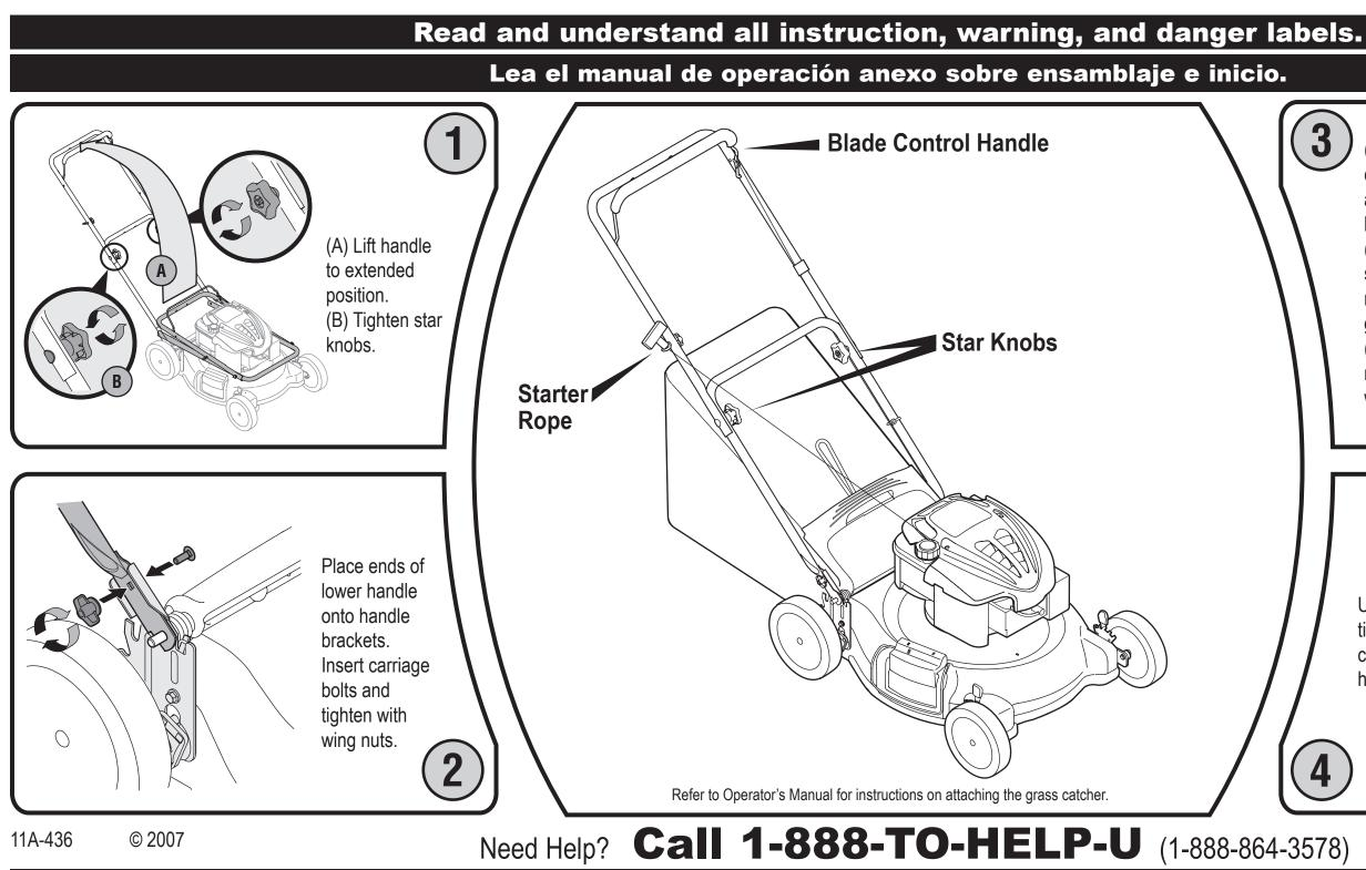
**IMPORTANT: READ OPERATOR'S MANUAL AND ENGINE MANUAL THOROUGHLY AND** FOLLOW THE SAFE OPERATION PRACTICES BEFORE OPERATING.
